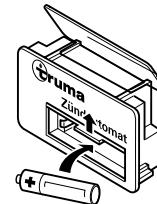
Pousser le couvercle du compartiment à pile vers le haut et remplacer la pile. Veiller au « plus/moins ». Refermer le compartiment à pile.
