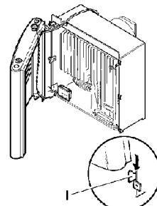
15. Fixer le câble d'adaptateur depuis l'arrière au système automatique d'allumage (il n'est pas nécessaire de respecter une certaine polarité).
