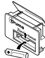
Heizungsverkleidung abnehmen (siehe Einbuanweisung), Batteriefachabdeckung nach oben schieben und Batterie wechseln. Plus/Minus beachten. Batteriefach wieder schließen.
