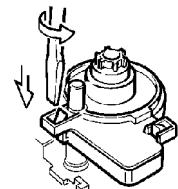
5. Dans le couvercle (6), pratiquer une ouverture pour la traversée du câble à l'aide d'un couteau, d'une scie ou d'une pince diagonale.
