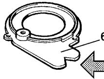
6. Insérer le microcontacteur (7) avec câble de raccordement (8) dans la soupape de sûreté d'allumage (5) de telle sorte que le ressort du contact pointe en direction de la bague tournante (goupilles de fixation intégrées dans le boîtier).
