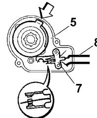
7. Deckel wieder aufschrauben bzw. aufdrücken und Druckstange einstecken.
