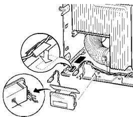
15. Adapterkabel von hinten am Zündautomaten aufstecken (es muss auf keine Polarität geachtet werden).
