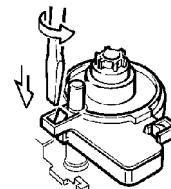
5. Im Deckel (6) mit Messer, Säge oder Seitenschneider eine Öffnung für die Kabeldurchführung anbringen.
