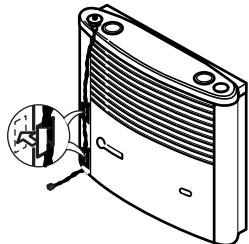
14. Coller une autre attache de câble sur le socle.
