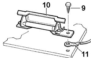
9. Positionner le câble de raccordement (8) par rapport à l'automate d'allumage (12) de telle sorte que les câbles ne soient pas affleurés à l'échangeur de chaleur ou au tuyau d'évacuation. Utiliser les points de fixation prévus sur la plaque d'assise.
