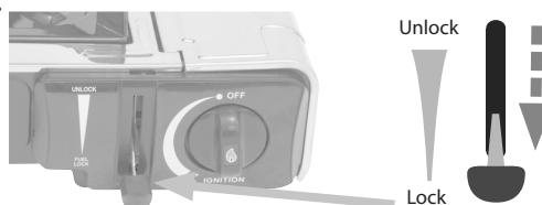
Maintenant que la cartouche de gaz est en place, baissez le levier de verrouillage en position Verrouillage/Lock.
