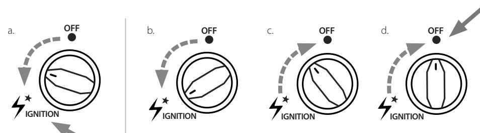
a.) Hořák zapálíte otáčením ovládacího knoflíku proti směru hodinových ručiček směrem k nápisu IGNITION, dokud neuslyšíte cvaknutí. Cvaknutí značí zapálení hořáku.
