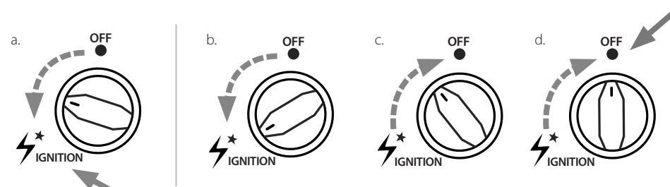
a.) Den Brenner zünden, indem Sie den Regler gegen den Uhrzeigersinn in Zündrichtung drehen, bis er hörbar einrastet. Das Klicken stellt die Zündung dar. Der Brenner sollte jetzt zünden.
