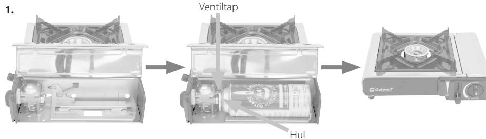
Luk gaskammeret op, og sæt gasbeholderen i.
