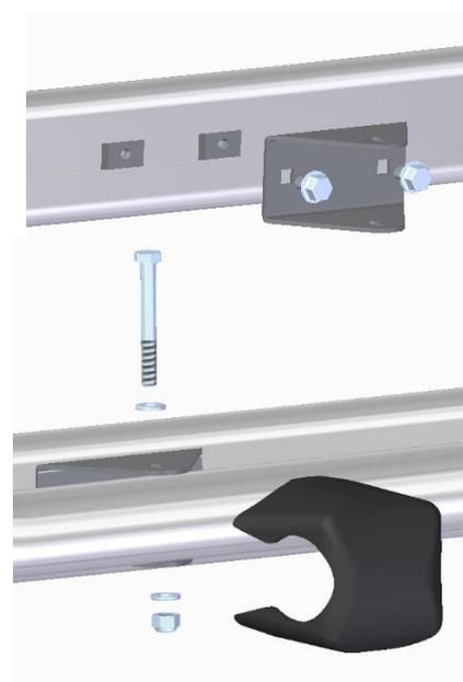
Nun kann der Schienenträger (6) eingesetzt und mit den Sechskantschrauben M6x60 mm handfest angezogen werden (ca. 2 - 3Nm), so dass sich der Schienenträger noch leicht hochklappen lässt. Danach werden die Befestigungskralle (4 + 5) am oberen Bügel montiert.
