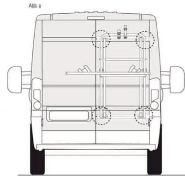
Prüfen Sie bitte nach der Montage alle (auch die vormontierten) Schraubverbindungen nochmals auf Ihre Festigkeit! Wiederholen Sie diese Prozedur nach spätestens 50km Fahrstrecke nochmal!
