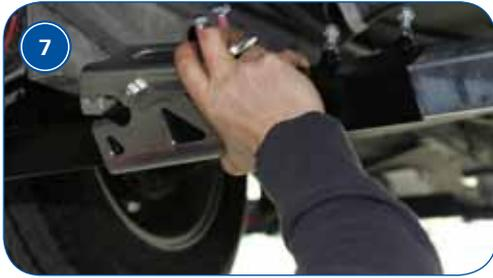
Hängen Sie den Mover® mit den Befestigungssystemen am Fahrzeugrahmen ein.
