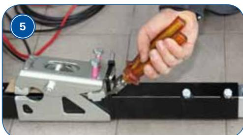
Lösen Sie beide Transportsicherungen, indem Sie die Kabelbinder aufschneiden.
