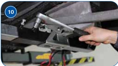
Arretieren Sie nun die Antriebseinheit auf der Querstange, indem Sie die 2 Schrauben pro Seite mit **je 20 Nm** anziehen.
