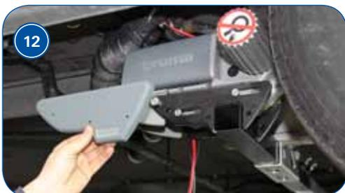
Nach der Montage der Abdeckplatten und der Positionsanzeige ist der Anbau der Mover®- Antriebseinheit fertig.
