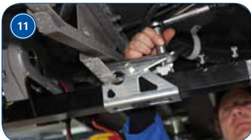
**20 mm Abstand Rolle- Reifen nochmals überprüfen.** Die beiden Schrauben pro Befestigungssystem **mehrmals** im Wechsel mit 25 Nm anziehen.
